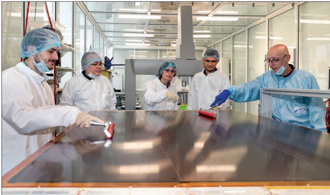
Лаборатория ядерных проблем им. В. П. Джелепова. Подготовка считывающей панели перед сборкой детектора Микромегас
