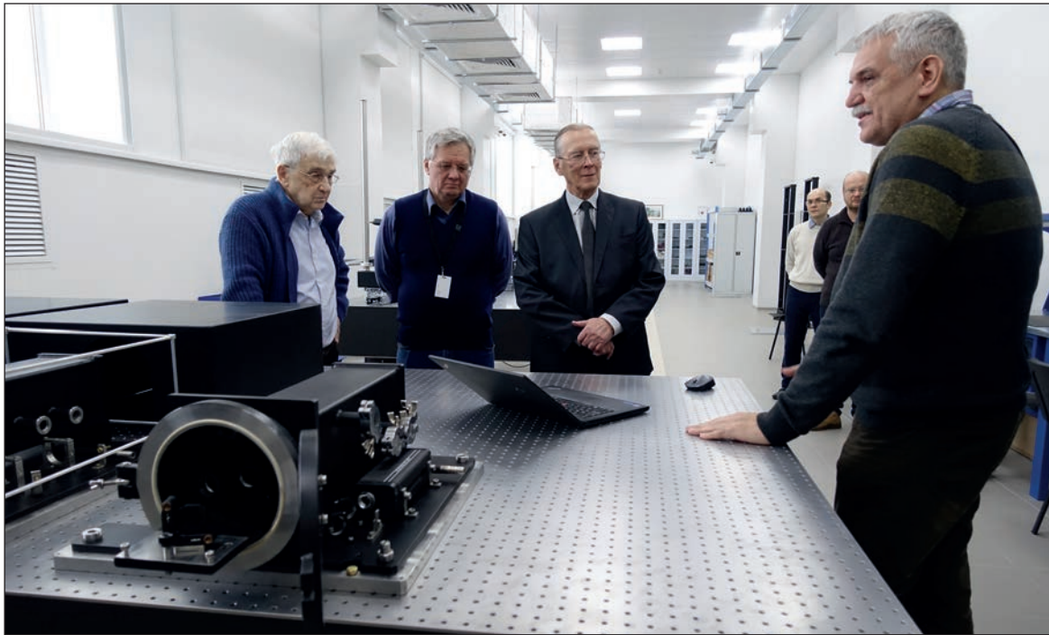
Лаборатория ядерных проблем им. В. П. Джелепова. Прецизионный лазерный инклинометр (ПЛИ) — инновационный прибор для измерения наклонов земной поверхности во времени с чувствительностью 2,4 \cdot 10^{-11} рад/Гц 1/2 в частотном диапазоне 10^{-3} –12,3 Гц. В настоящее время ПЛИ используется на интерферометрической гравитационной антенне VIRGO и на коллайдере LHC
