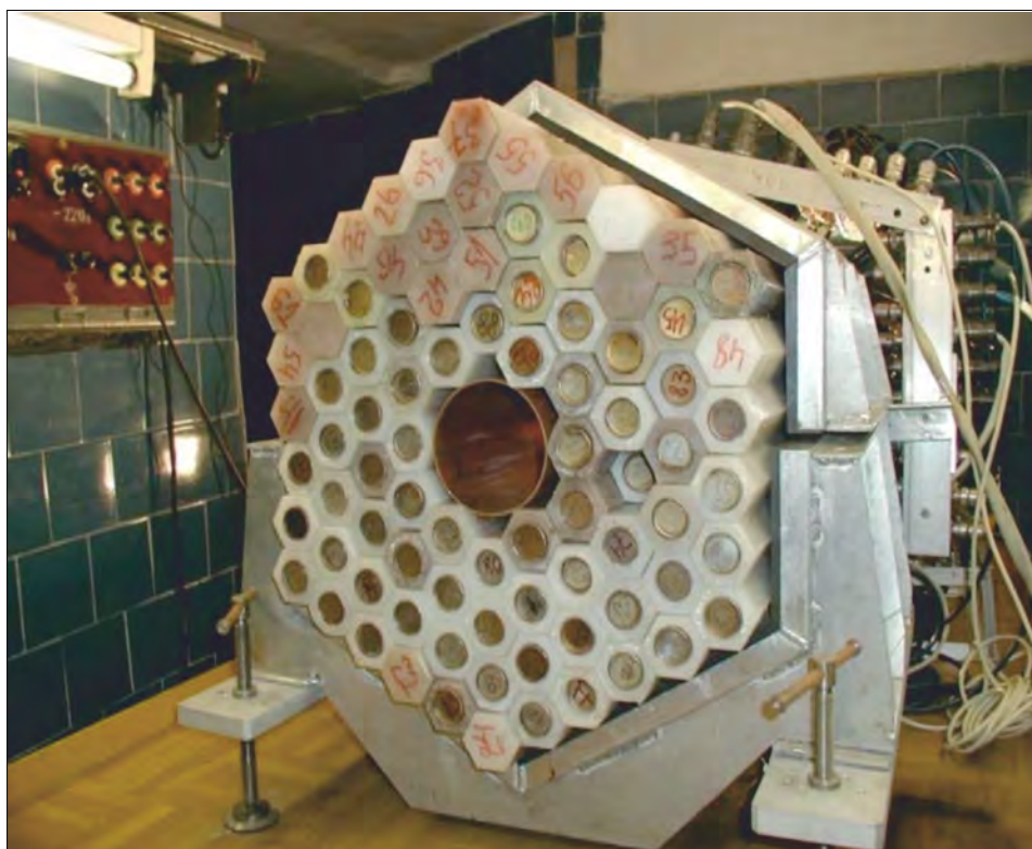
Нейтронный детектор 4 \pi -геометрии TETRA на основе ^3\text{He} -счетчиков
