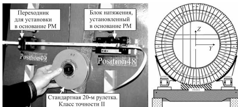
Рис. 21. Схема измерений прецизионной рулеткой
