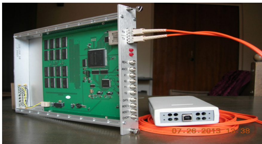
Рис. 6. Модуль De-Li-DAQ-2D для сбора и накопления данных с ПЧД
