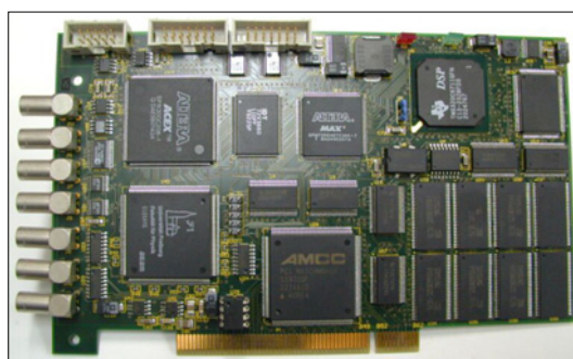
Рис. 5. Модуль De-Li-DAQ-1 сбора и накопления данных с ПЧД
