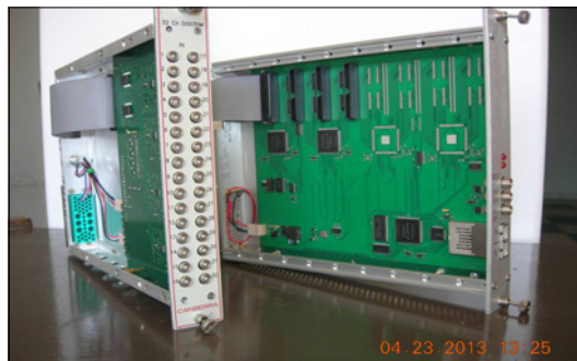
Рис. 4. Блоки MPD (слева — аналоговый, справа — цифровой)
