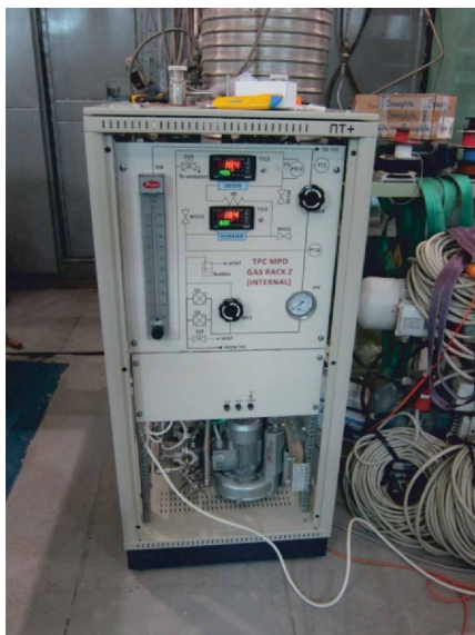
Рис. 10. Стойки управления газовой системой ТРС
