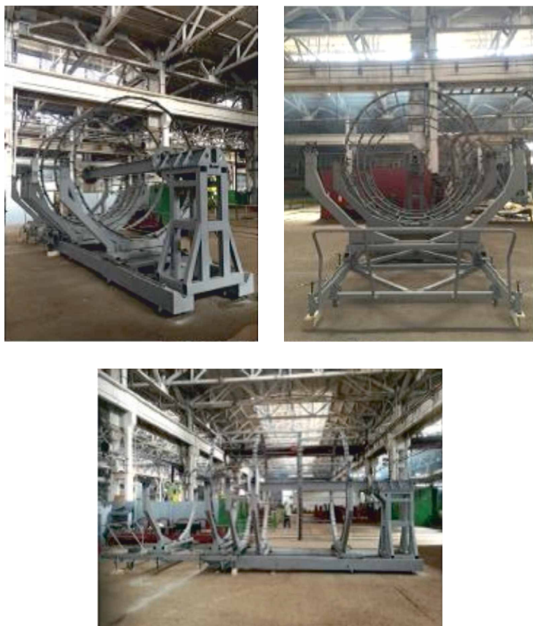
Рис. 4. Специальные приспособления для сборки ТРС
