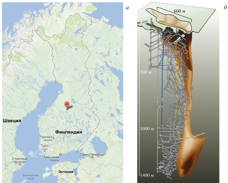
Рис. 1. Географическое месторасположение шахты Пюхасалми ( а ) и ее вертикальный разрез ( б )
