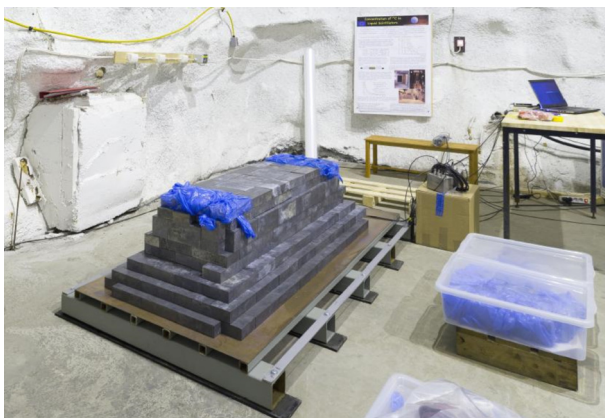
Рис. 5. Специализированная установка для измерения концентрации изотопа ^{14}\text{C} в жидких сцинтилляторах, собранная в низкофоновой лаборатории в шахте Пюхасалми
