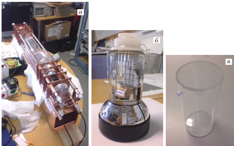
Рис. 4. Элементы специализированной установки для измерения в низкофоновой лаборатории в шахте Пюхасалми концентрации изотопа ^{14}\text{C} в жидких сцинтилляторах: а) сборка установки; б) низкофоновый фотоумножитель ET9302B; в) кварцевая стеклооболочка
