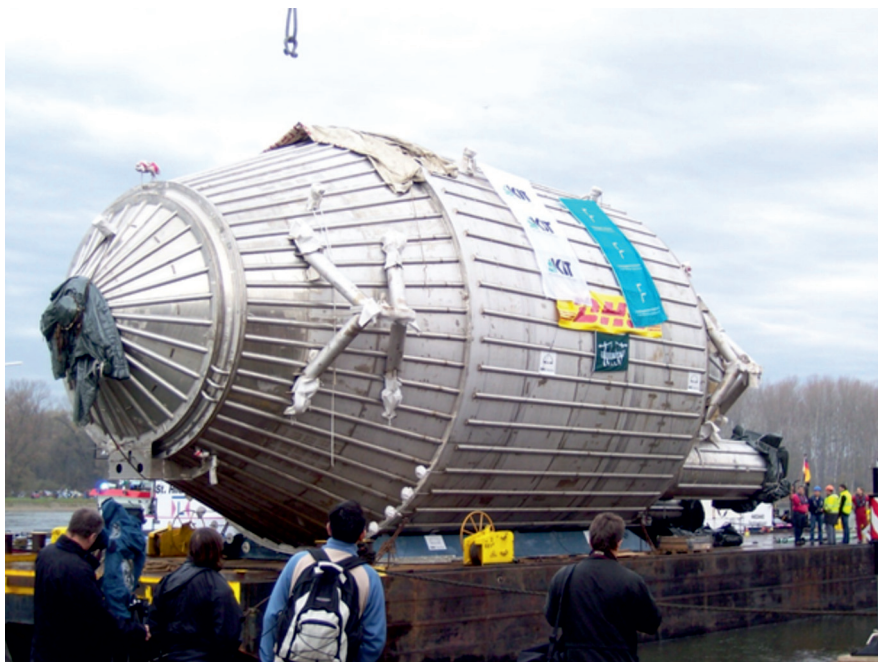
Рис. 4. Один из эпизодов заключительного этапа транспортировки вакуумной камеры главного спектрометра проекта KATRIN массой 200 т с завода-изготовителя в КИТ (Карлсруэ)
