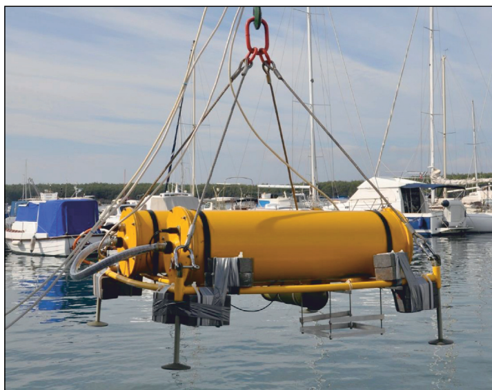
Рис. 43. Модуль досмотра для подводной установки [64]
