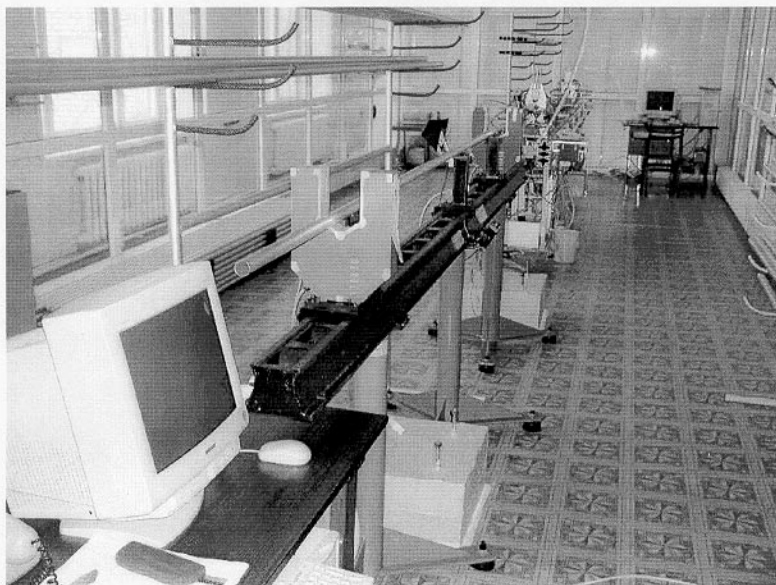
Рис.9: Интерьер ЧПП. На переднем плане - линия измерителя диаметра алюминиевой трубы. На заднем – линия сборки дрейфовых трубок
