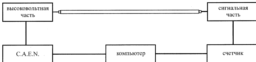
Рис. 12. Принципиальная схема стенда для высоковольтного тестирования дрейфовых трубок
