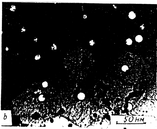
Рис.3. Микроструктура Al, облученного ионами Хе ( E=124 МэВ) флюенсом 1,3 \times 10^{16} см -2 и отожженого 8 ч при 480°C (a) и 600°C (b).
