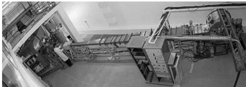
Рис. 1. Тракт выведенного пучка установки. Слева виден циклотрон, справа — камера для облучения пленки
