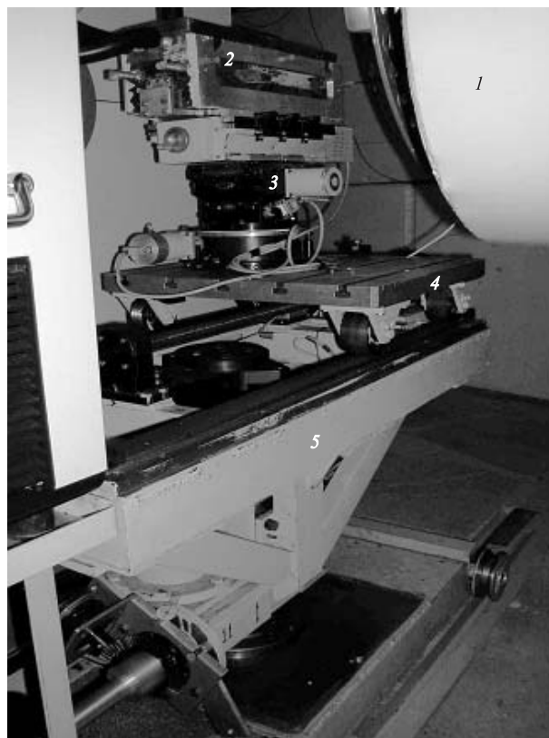
Рис. 6. Стол образцов и гониометрический узел: 1 — юстируемый коллиматор; 2 — термобокс; 3 — гониометрический узел; 4 — тележка стола образцов; 5 — станина стола образцов
