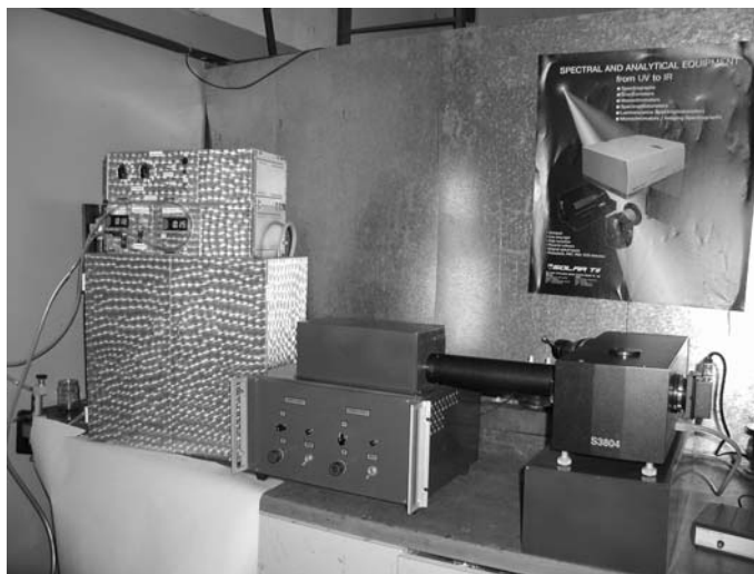
Рис. 3. Прототип атомно-эмиссионного спектрометра с системой пробоподготовки
