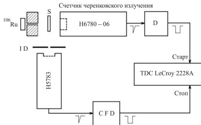
Рис. 3. Установка для измерения времени высвечивания
