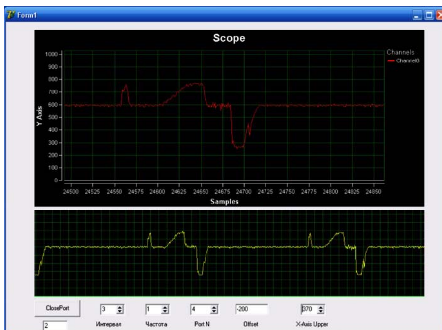
Рис. 9. Сигнал после некоторого разбаланса измерительного моста датчика
