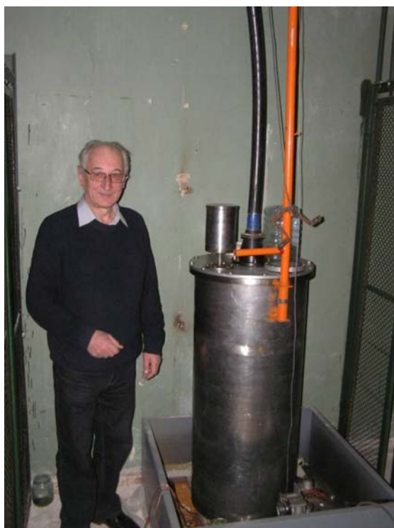
Рис. 14. Слева — существующий высоковольтный генератор источника питания ЭСС, справа — новая умножающая колонна с напряжением до 200 кВ
