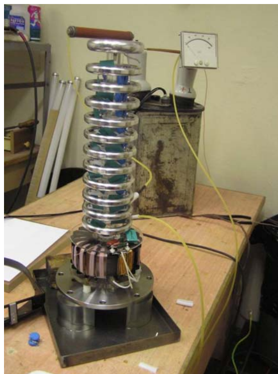
Рис. 14. Слева — существующий высоковольтный генератор источника питания ЭСС, справа — новая умножающая колонна с напряжением до 200 кВ
