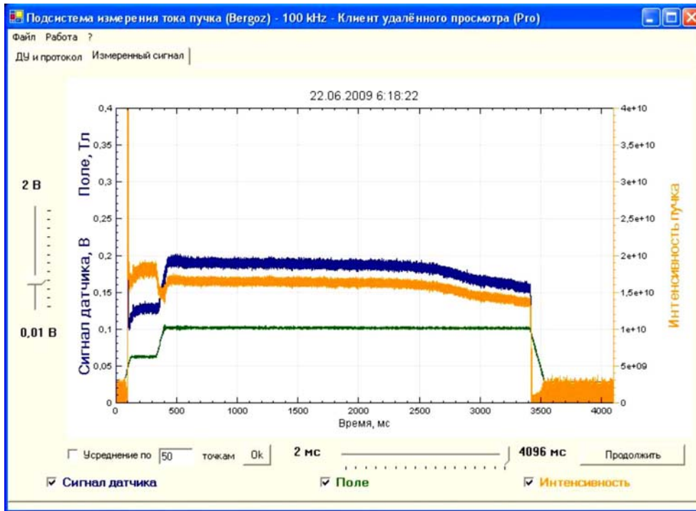
Рис. 3. Сигналы параметрического трансформатора тока, соответствующие режиму с двумя «столами» магнитного поля. Нижняя кривая соответствует опорному сигналу магнитного поля, средняя — интенсивности пучка в количестве циркулирующих ионов, верхняя — показаниям трансформатора в вольтах
