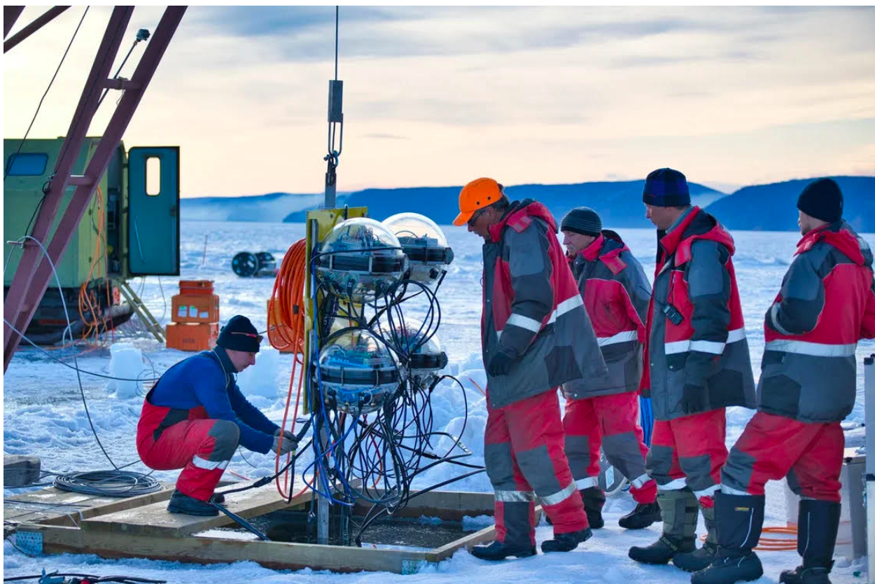
Сборка стринга на седьмом кластере на фоне заходящего солнца. Фото Баира Шайбонова.
