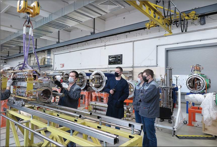
На снимке: подготовка к криогенным испытаниям 1-го серийного квадрупольного магнита коллайдера NICA. Слева направо: Дмитрий Морозов, слесарь механосборочных работ; Максим Ильин, лаборант; Алексей Свидетелев, Сергей Коровкин, начальники групп.
