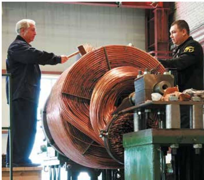
Процесс создания витых трубчатых теплообменников
