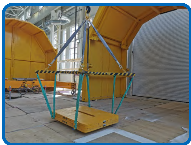
Рис. 7. Слева: Испытание траверсы для монтажа теплых катушек. Справа: Монтаж нижней части 4-уровневой подвижной платформы. Fig. 7. On the left: Testing the traverse for the installation of trim coils. On the right: Installation of the lower part of a 4-level movable platform.
