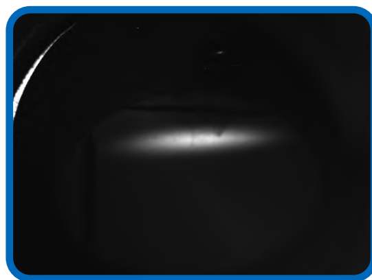
Рис. 3. Пучок ионов ^{56}\text{Fe}^{14+} на люминофорном экране в конце канала транспортировки пучков Бустер-Нуклотрон. Fig. 3. A beam of ions ^{56}\text{Fe}^{14+} on the phosphor screen at the end section of the Booster-Nuclotron transport channel.
