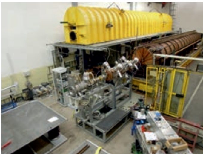
Форинжектор ЛУ-20 при сборке
