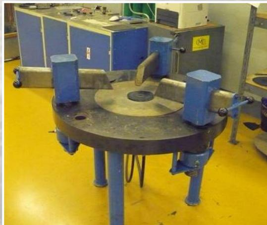
**Zkoušení pojišťovacích ventilů**
