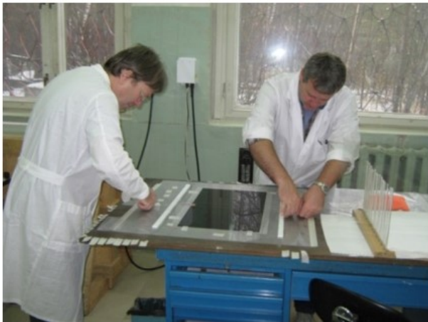
Рис. 11. Фотографии сверху – изготовление камер MRPC, внизу – тестовые стенды в Протвино. Fig. 11. Production process of MRPCs (upper pictures). Test benches in Protvino (bottom pictures).
