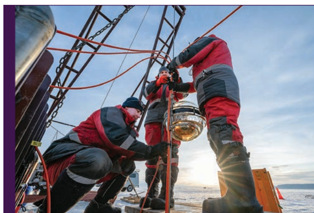
Байкал, апрель. Монтаж гирлянды оптических модулей нейтринного телескопа Baikal-GVD
