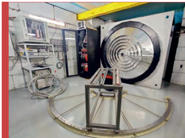
Вид детектора со стороны образца: поворотная платформа для двухкоординатного ПЧД-детектора и модули окружения образца, детектор обратного рассеяния и система накопления данных
