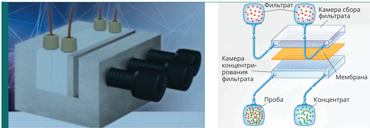
Рис. 2. Препаративная система тангенциальной фильтрации для R&D и биотехнологий (ЦПФ ЛЯР)
