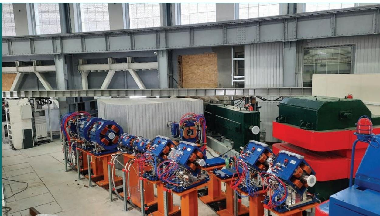
Лаборатория физики высоких энергий им. В. И. Векслера и А. М. Балдина. Каналы транспортировки пучков в зоне прикладных исследований на базе выведенных пучков ускорительного комплекса NICA
