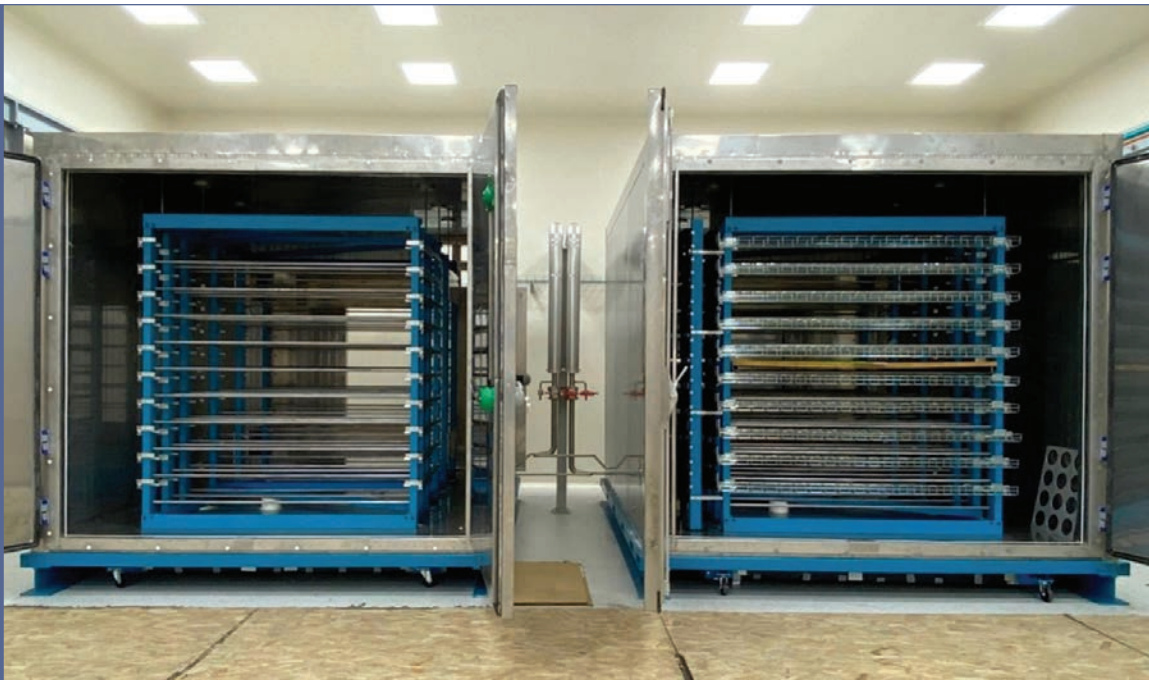
Теплоизолированные камеры стенда для проверки кассет калориметра высокой гранулярности HGCal, CMS
