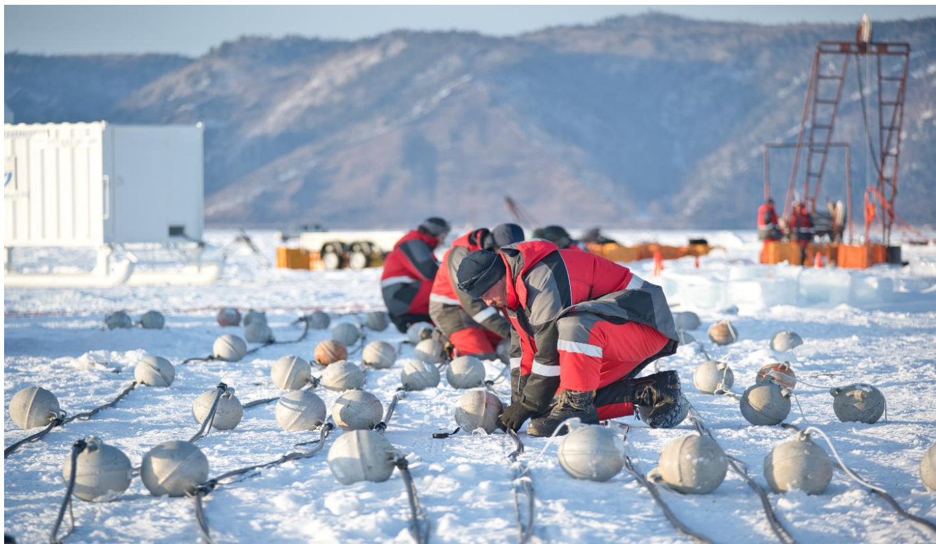
Рис. 12. Сборка гирлянды кластера установки Baikal-GVD
