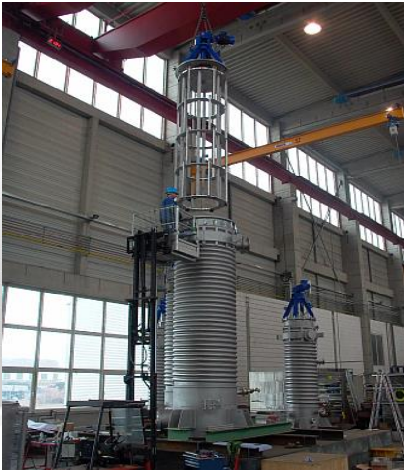
Корпус вакуумной дистиллирующей установки на этапе монтажа конденсатора
